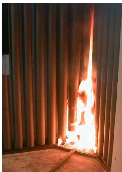
Figur 2: SBI-testen, vist her med cellegummislanger, før, under og etter testen
