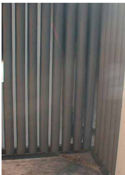
Figur 2: SBI-testen, vist her med cellegummislanger, før, under og etter testen
