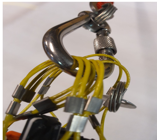
Fig.1 Alle løkkene må tres inn på karabinkrok.
